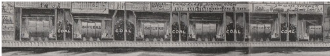
Figure 5: Représentation des six chaufferies du Titanic. La gauche, la chambre de chauffe la plus en avant, la chaufferie n° 6. Elle est suivie par la chaufferie n° 5, et ainsi de suite jusqu'à la chaufferie n° 1.
